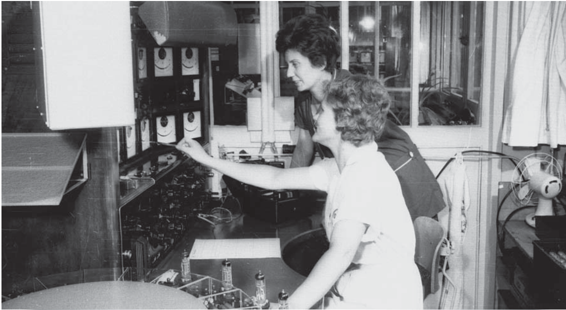
Arbeiten am Messtisch für Verbundröhren, um 1965
