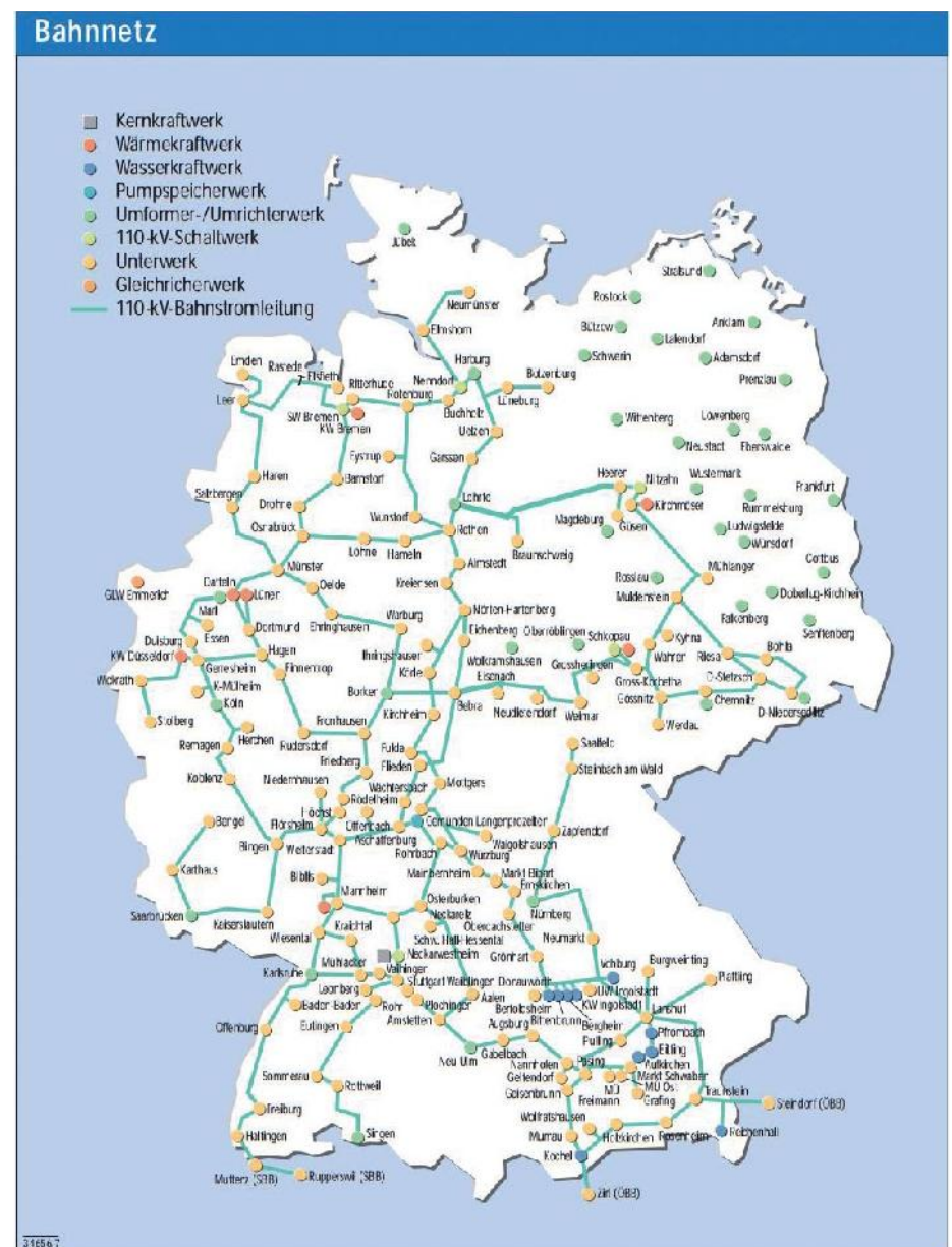
Bild 15: 110-kV-Bahnnetz, 16 \frac{2}{3} Hz, Stand 01.09.1996 [5]
