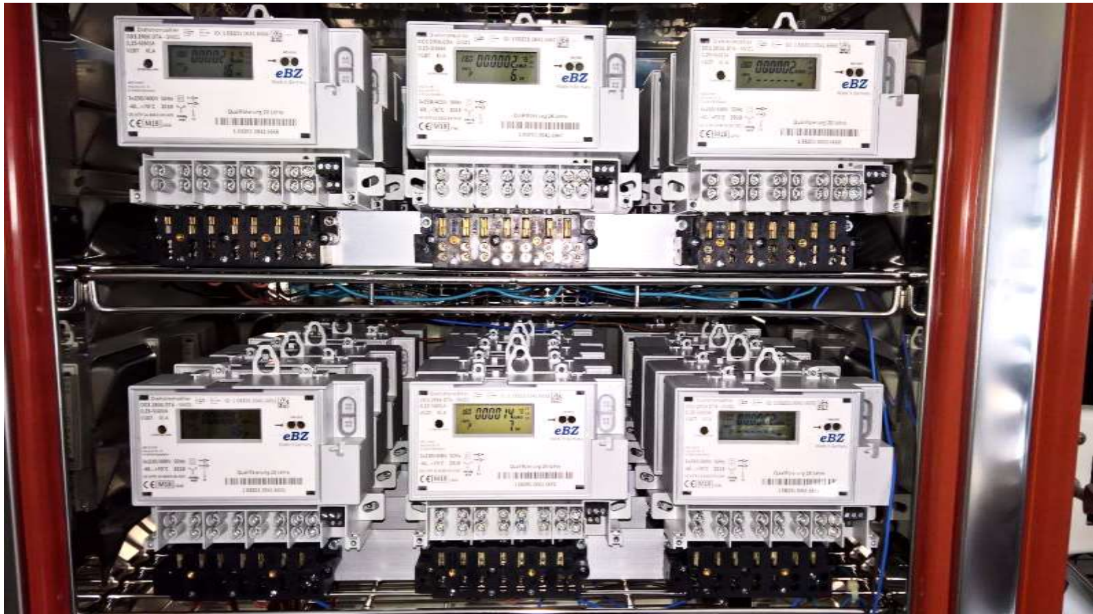
30 Zähler DD3 im Klimaschrank
