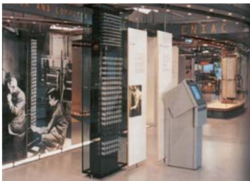
1947 Großrechner »ENIAC« (US) arbeitet mit 14 468 Elektronenröhren.
